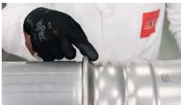
Рис. 36. Визуальный осмотр места прессования Oversize.
