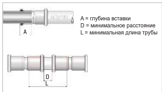
Рис. 27. Глубина вставки и минимальные размеры.
